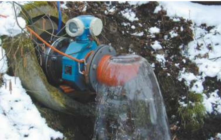
Beispiel: Referenzmessung mit mobilem MID
